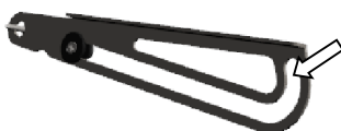
Abbildung 11: Finaler Blockierbereich in der Führung des Bügels, in den die Buchse gleiten muss, um ein Schließen der Klappe zum falschen Zeitpunkt zu vermeiden
